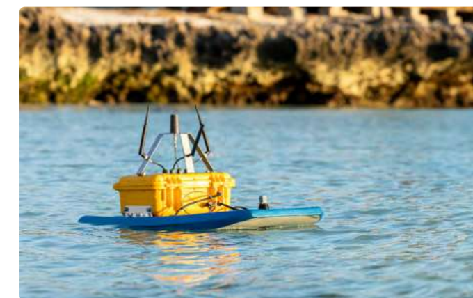
Figure 28. "Planche" munie d'un échosondeur, d'un GPS, et de caméras © Ifremer
