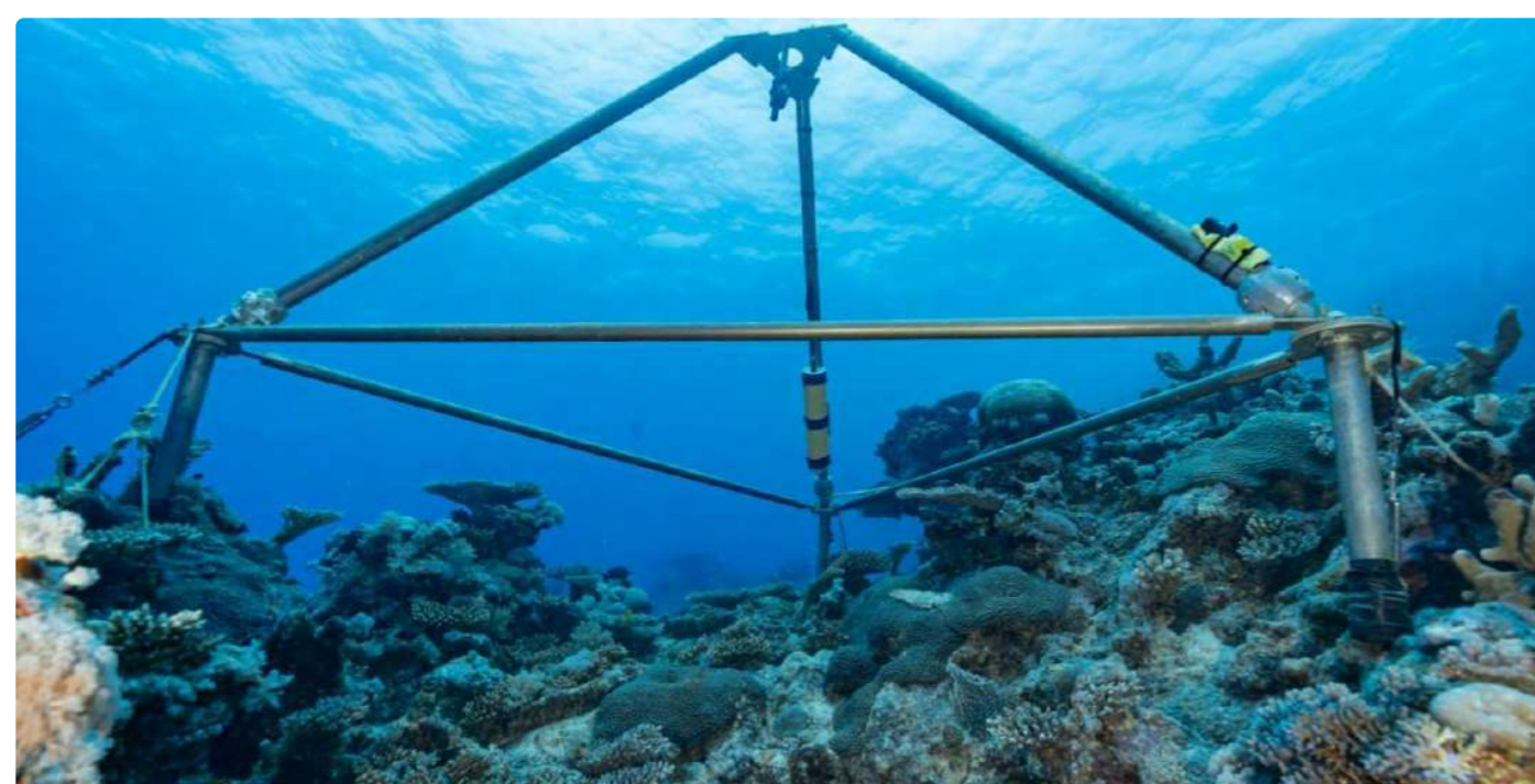
Figure 43. Photo d'un dispositif déployé par ReefPulse dans le cadre du projet SONOMAY © Sébastien Quaglietti / OFB - Parc Naturel Marin de Mayotte.
