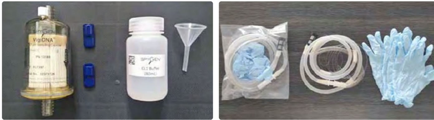
Figure 39. Capsule de filtration, bouchons et tampon de conservation (gauche) et tuyau muni d'une crépine et paire de gants. Images extraites du rapport Giraud et al. (2024) © SPYGEN
