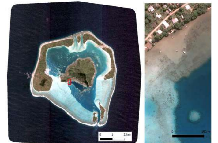
Figure 53. Exemple d'une image multispectrale Pléiades (50 cm de résolution spatiale après pansharpening) de Maupiti en Polynésie française © CNES and AIRBUS DS 2021
