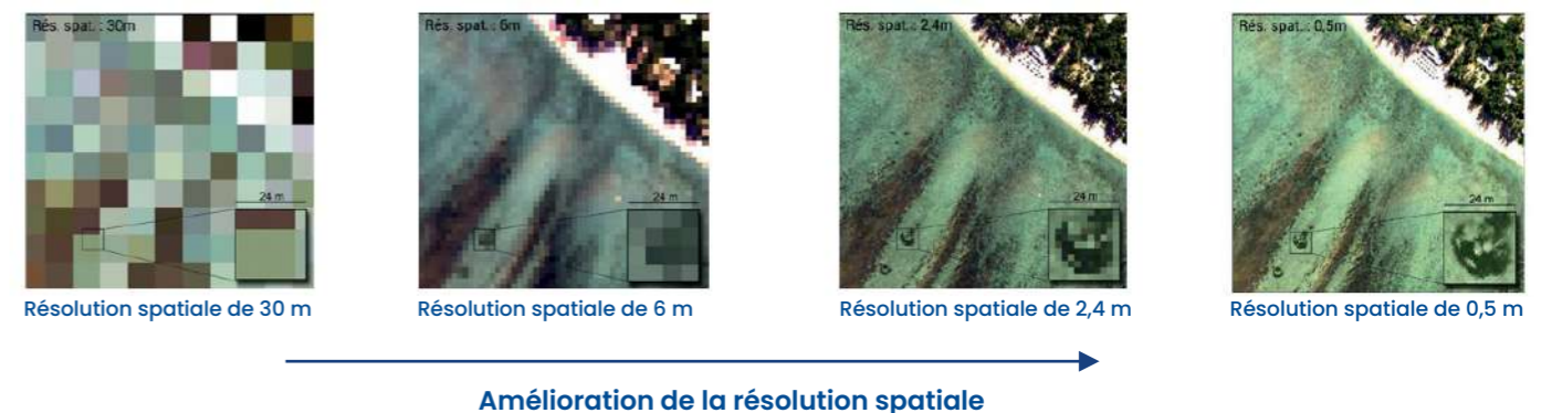
Figure 56. Illustration de la notion de résolution spatiale, inspirée de Nicet et al., 2016
