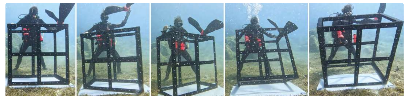
Figure 35. Série de photographies présentant la calibration pour une face du cube © Théo Granier/Office Français de la Biodiversité
