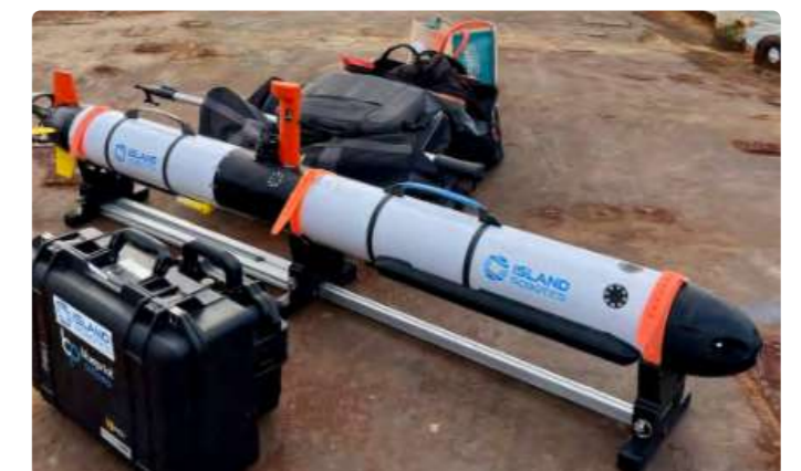
Figure 27. Robot sous-marin de type AUV en forme de torpille © Island Robotics
