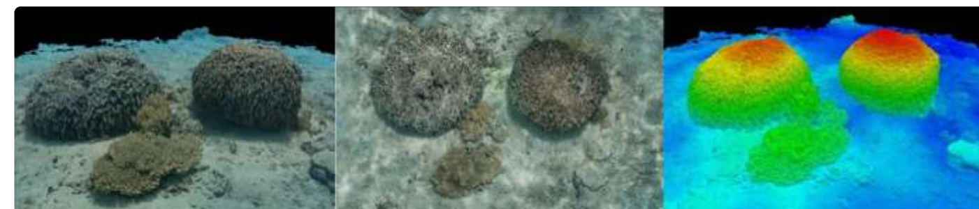
Figure 6. Les différents rendus de la photogrammétrie permettent de visualiser trois colonies coralliennes en un modèle 3D (à gauche), une orthophotographie (au milieu) et un Modèle Numérique de Terrain (à droite).
