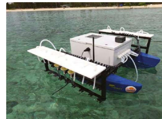
Figure 40. "catamaran" muni des filtres ADNe - projet p-PUMPIT © Ifremer
