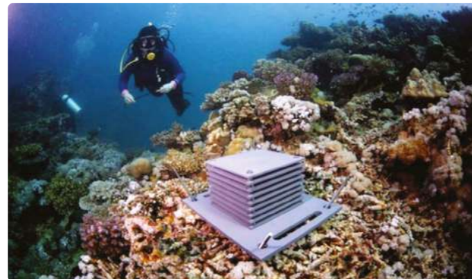
Figure 79. ARMS déployé en Indonésie et fixé à l'aide de quatre piquets en acier inoxydable © Chris Meyer
